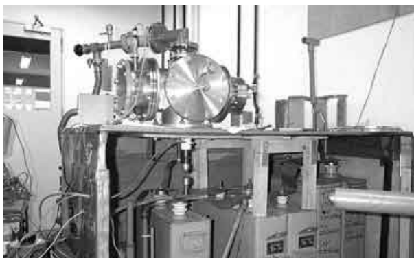
写真1 表面窒化処理用窒素プラズマのレーザー誘起傾向測定装置
