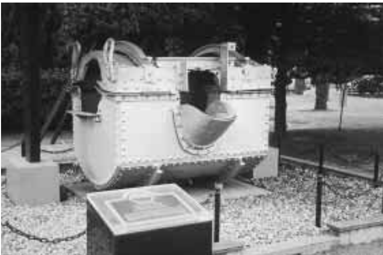
現存する我が国最古のエルー式電気炉。大正5年、電気製鋼所はこの炉で工具鋼の生産を開始した。(大同特殊鋼社宝として同社知多工場に展示) 米国金属協会から歴史的遺産として、世界で59番目、日本では2番目に認証された。
